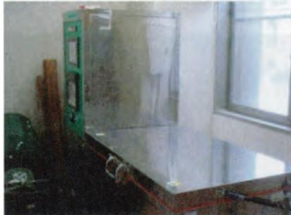
写真-4 凍結融解試験装置
