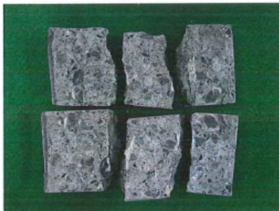
写真-3 コンクリートコア割裂状況
